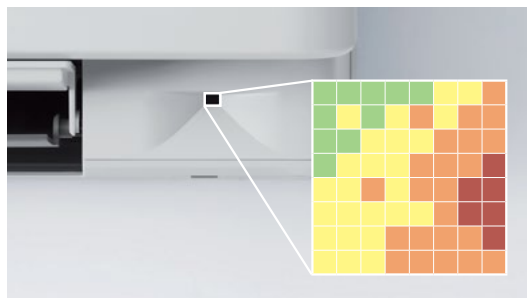
Der Grid-Eye-Sensor unterteilt die Raumbofläche in 64 Quadrate, um ihre Temperatur genau zu bestimmen.
